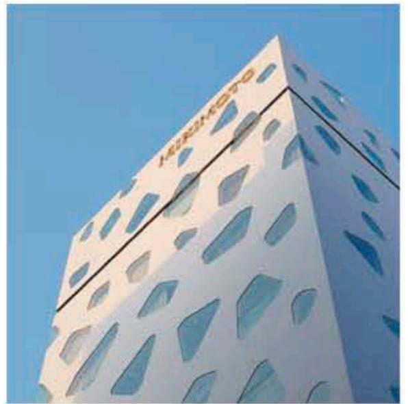
**Ф**асад 10-этажного дома Chanel на Чуо-дори нью-йоркский архитектор Питер Марино украсил специальным полупрозрачным стеклом, становящимся совсем прозрачным под действием электричества. 700 000 светодиодных лампочек вечером превращают современные строгие стены из стекла в сплошной поток света. Этот свет управляем, он попеременно воспроизводит разные узоры, в том числе фирменный знак Chanel.
